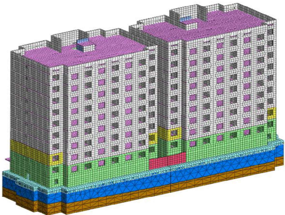
24 - сурет – 6 м қалыңдықтағы топырақ жастығы бар ғимараттар мен топырақ массивінің есептік схемасы
